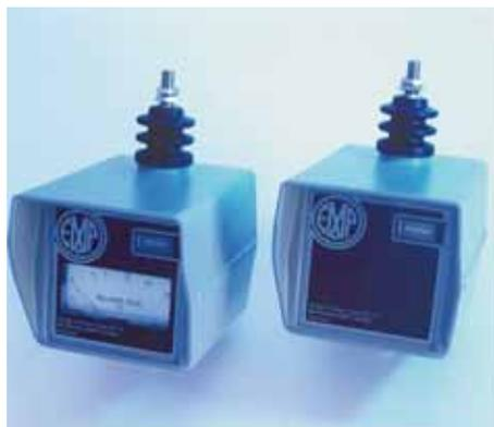
Счетчики импульсов компании «Тайко Электроникс Боуторп» предназначены для работы с ОПН любых производителей. Счетчик SC 12 имеет только одну функцию – подсчет импульсов; счетчик SC 13 – дополнительно измеряет токи утечки. Аналоговый прибор измеряет ток, проходящий через ОПН, и токи утечки по поверхности корпуса ОПН. Значительные изменения в показаниях прибора с момента его установки говорят о повреждении ОПН или о загрязнении поверхности корпуса.
