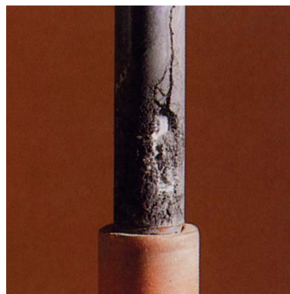
Поверхность полиэтилена (черного цвета) после испытания в течение 48 часов
